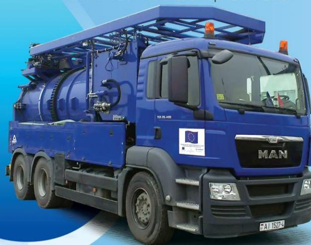
Специализированная каналопромывочная машина «Assmap» на базе MAN в рамках Программы трансграничного сотрудничества Латвия-Литва-Беларусь 2007-2013.
